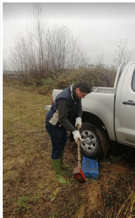
Figura 2. Acquisizione di dati: a) stendimento per acquisizione dati utili ad analizzare la dispersione delle onde di Love; b) stendimento per acquisizione dati utili ad analizzare la dispersione delle onde di Rayleigh (componente radiale). Nella fotografia a destra la battuta di taglio su piastra in polipropilene.
